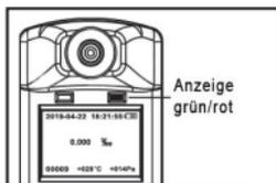
Nach der Analyse wird Ihr Messergebnis für 15 Sekunden auf dem Display angezeigt. Die Anzeige leuchtet grün, wenn das Ergebnis unter dem voreingestellten Grenzwert (i.d.R. 0,5 ‰) liegt.
